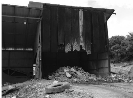
รูปที่ 2-10: การปิดคลุมถังรับหินใหญ่
